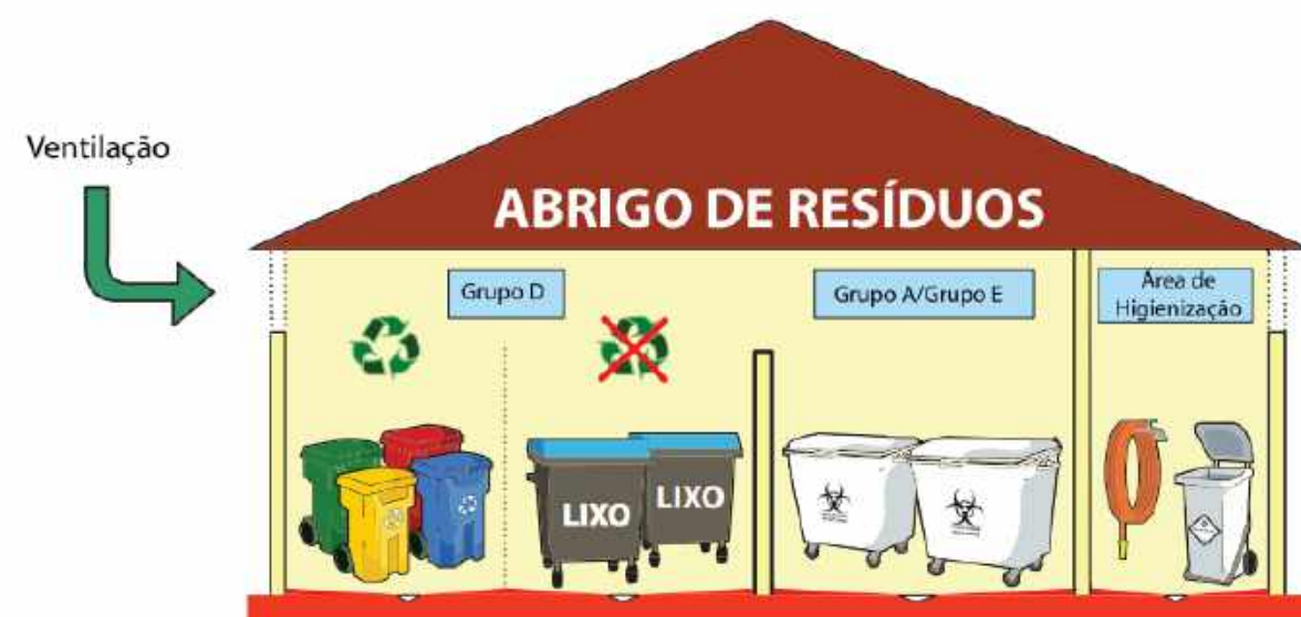
Figura 65 - Ilustração da instalação de abrigo adequado para o armazenamento externo de resíduos do Grupo A, Grupo D e Grupo E.
