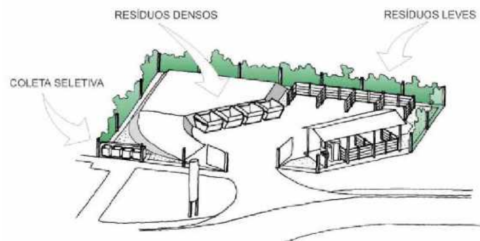
Figura 72 – Layout sugerido para a implantação de Ecopontos nos municípios integrantes do PIGIRS-CIDEMA. Fonte: Ministério das Cidades, Ministério do Meio Ambiente e Caixa Econômica Federal.
