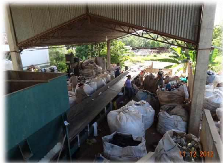
Figura 57 - Vista do galpão principal da Unidade de Triagem de Resíduos Sólidos de Bonito/MS, onde é realizada a triagem dos resíduos sólidos oriundo da Coleta Seletiva do município. Fonte: Deméter Engenharia Ltda., Foto tirada em 11/12/2012.
